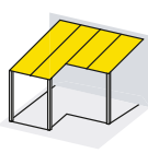
Toit en appentis avec déport de gouttière
