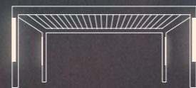
Bandes LED couleur sur la partie haute des montants, côté extérieur (longueur : 1600 mm)
